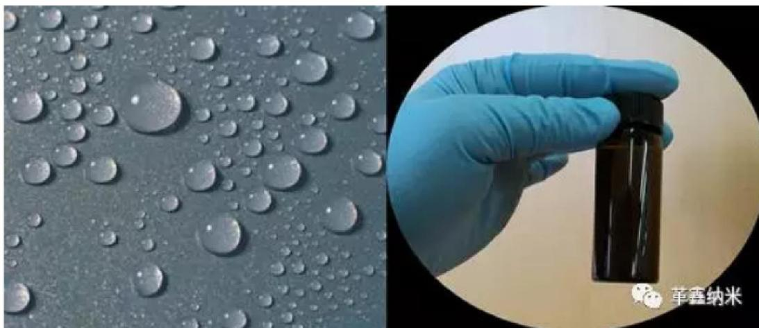
有机硅，是一类人工合成的，结构上以硅原子和氧原子为主链的一种高分子聚合物。由于构成主链的硅-氧结构具有较强的化学键结，因此有机硅高聚物的分子比一般有机高聚物对热、氧稳定得多。有机硅独特的结构，使其兼备了无机材料与有机材料的性能，具有表面张力低、粘温系数小、压缩性高、气体渗透性高等基本性质，并具有耐高低温、电气绝缘、耐氧化稳定性、耐候性、难燃、憎水、耐腐蚀、无毒无味以及生理惰性优异特性，广泛应用于航空航天、电子电气、建筑、运输、化工、纺织、食品、轻工、医疗等行业，其中有机硅主要应用于密封、粘合、润滑、涂层、表面活性、脱模、消泡、抑泡、防水、防潮、惰性填充等。
