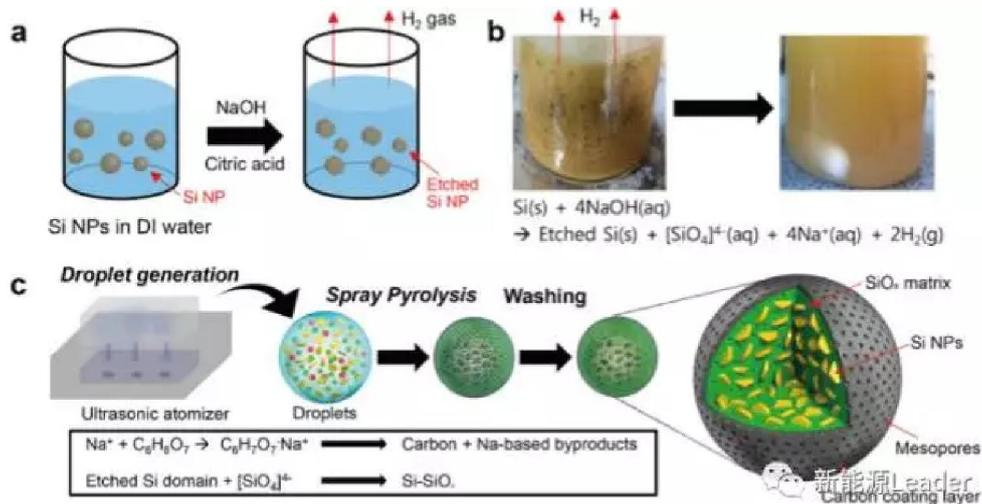
为了克服 SiOx 材料首效低的问题，人们对其结构进行了众多的改进，例如韩国学者 Seung Jong Lee 等<sup>[6]</sup>设计了一款 Si-SiOx-C 复合材料（如下图所示），该材料的可逆容量达到 1561.9mAh/g (0.06C)，首效可达 80.2%，1C 循环 100 次，容量保持率 87.9%。
