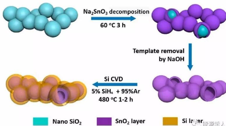
图 2. 中空 SnO<sub>2</sub>@Si 纳米球的 u 合成示意图
