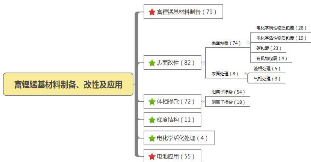
图 5-6-1 富锂锰基正极材料制备、改性及应用技术分类
